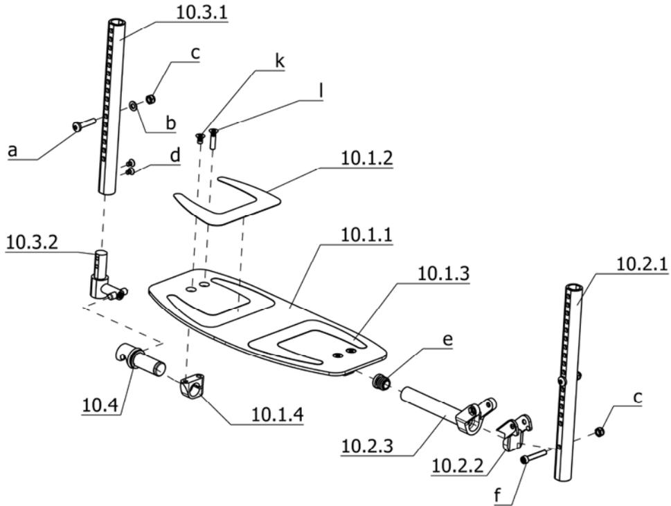
**U-Bg.: Code 315-4950; Fußstütze breit – hochklappbar - höhen- und winkelverstellbar – mit Rahmenverjüngung**
