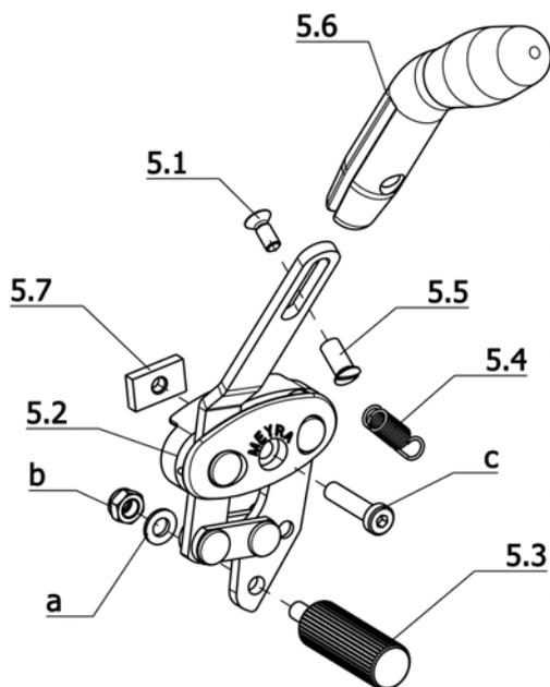
**U-Bg.: Code 681; Druckbremse mit abklappbaren Bremshebel**
