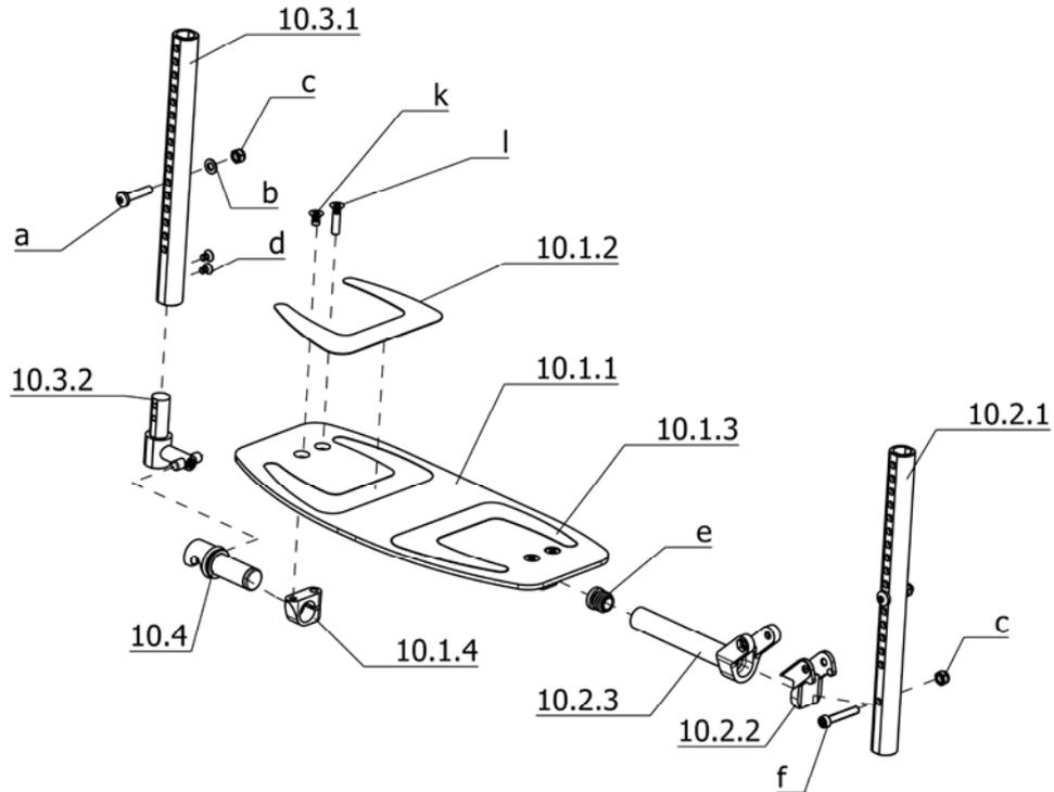
**U-Bg.: Code 315-4959; Fußstütze breit – hochklappbar - höhen- und winkelverstellbar ohne Rahmenverjüngung**
