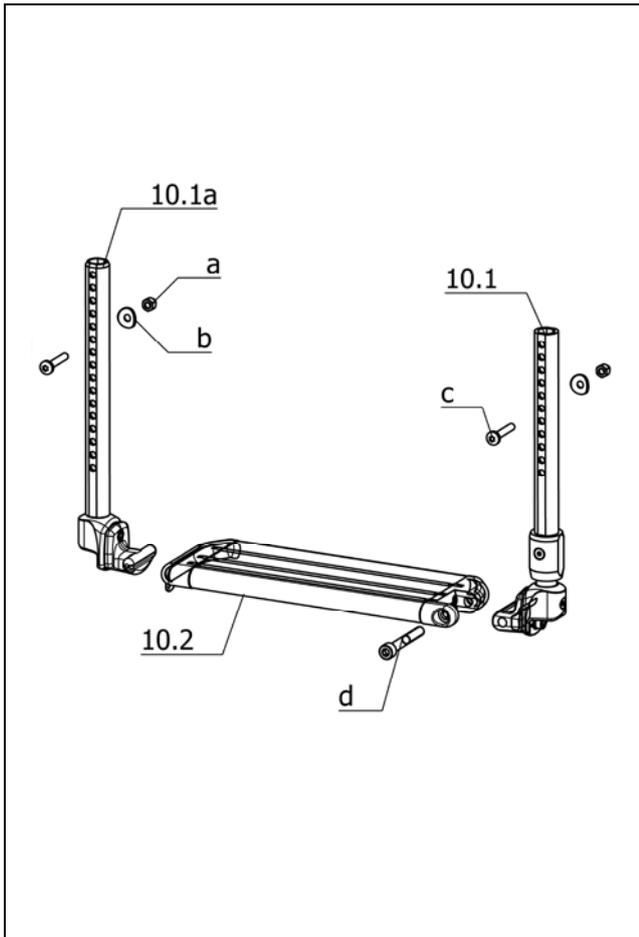
**U-Bg.: Code 312-663-4959; Sportbeinstütze – Fußplatte mit Gummiauflage – ohne Rahmenverjüngung**
