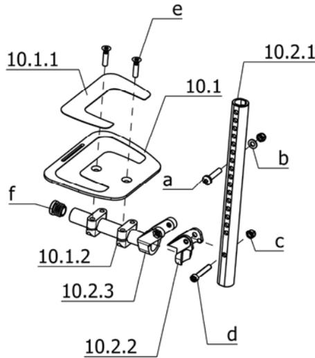
**U-Bg.: Code 808; Fußplatten winkelverstellbar**
