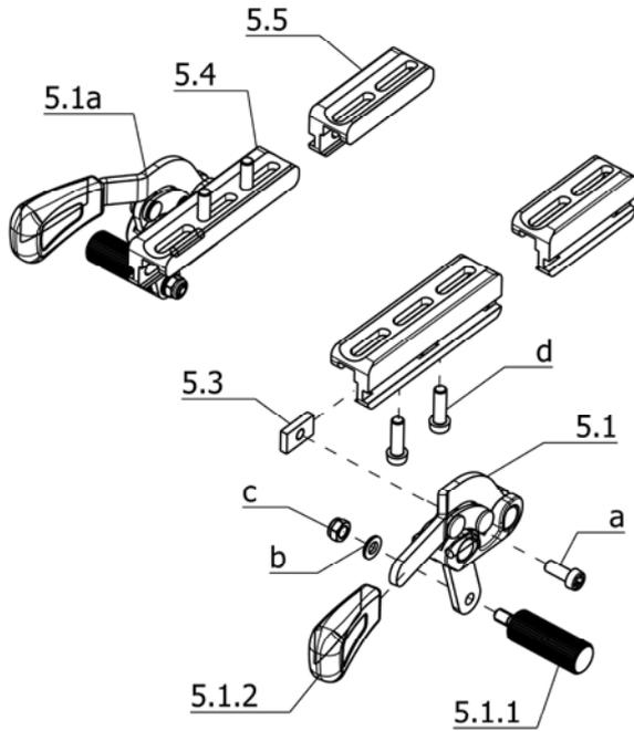
**U-Bg.: Code 81-305-486; Seitenteil – Druckbremse – 1 3/8"-Bereifung**
