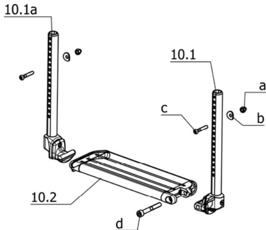
**U-Bg.: Code 312-4959; Sportbeinstütze mit Fußplatte und Gummiauflage – ohne Rahmenverjüngung**
