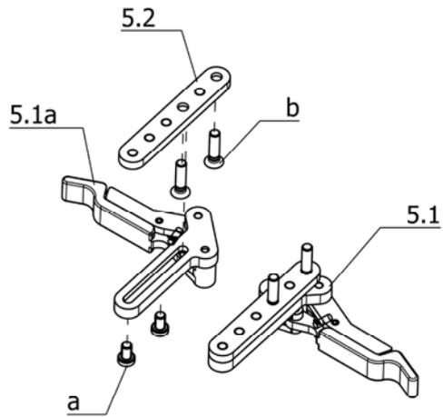
**U-Bg.: Code 2595; "Light" Druckbremse wegklappbar**
