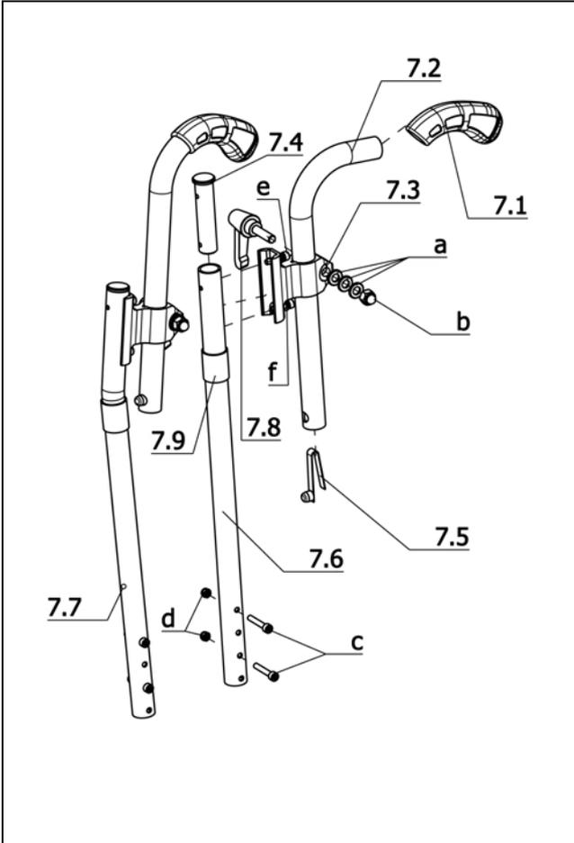
**U-Bg.: Code 502-621-622-706; Höhenverstellbare Schiebegriffe, mit und ohne Lumbalknick, i. V. mit Trommelbremse**
