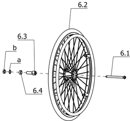
**U-Bg.: Code 651; abnehmbare Räder (Steckachse)**
